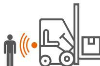
La fase di manovra è un momento particolarmente complesso e rischioso: l'attenzione focalizzata sul carico, ostacoli nascosti, pedoni in avvicinamento e veicoli in movimento sono i principali fattori di rischio. I **sistemi passivi SIS** sono progettati per prevenire le collisioni monitorando l'area di manovra e avvertendo il conducente.
