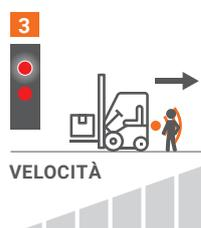
In presenza di veicoli di larghezza superiore a 1,5 metri la soluzione di assistenza attiva alla manovra si chiama **Safe&Stop+**: un sistema anticollisione che prevede due sensori a ultrasuoni sincronizzati tra loro in grado di monitorare un'area più ampia. Il dispositivo interviene avvisando il manovratore e, in caso di imminente impatto, rallentando\* e bloccando\* il mezzo.
