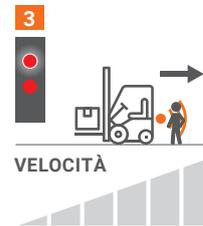
Quando **Safe&Stop**, attraverso il sensore a ultrasuoni posizionato sul retro del veicolo, rileva un ostacolo nel raggio d'azione allerta immediatamente l'operatore con segnali luminosi e acustici e attiva il sistema di rallentamento automatico del mezzo fino a fermarlo\*, evitando così qualsiasi tipo di collisione.
